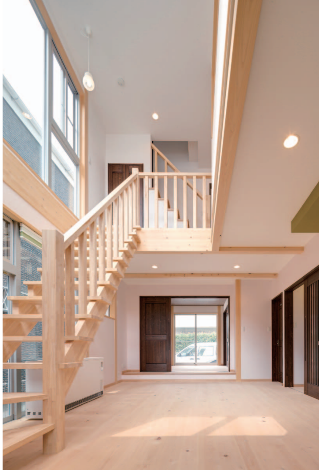
家に入った瞬間に圧倒的な木の香りに包まれる「新・香木の家」。基本設計に含まれている吹き抜けやストリップ階段による開放的な大空間に、薄いピンク色をした吉野ひのきの床や化粧の柱、土佐和紙の壁が映え、心癒される雰囲気を出し出す。見開き写真の写真はすべて施工例
